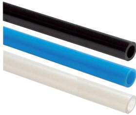
**Eigenschaften:** Die leichten und preisgünstigen Polyethylenschläuche eignen sich für einfache Anwendungen oder Anwendungen mit erhöhten Anforderungen an chemische Resistenz. Sie sind nicht knickstabil und neigen bei der Verarbeitung zum dauerhaften Verformen.
