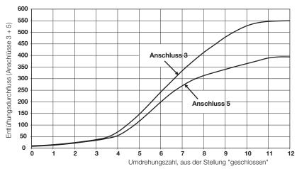
Durchfluss an den Anschlüssen 1 und 2 sowie 1 und 4 bleibt unverändert. Durchfluss gemessen bei 6 bar Eingangsdruck, Druckdifferenz 1 bar
