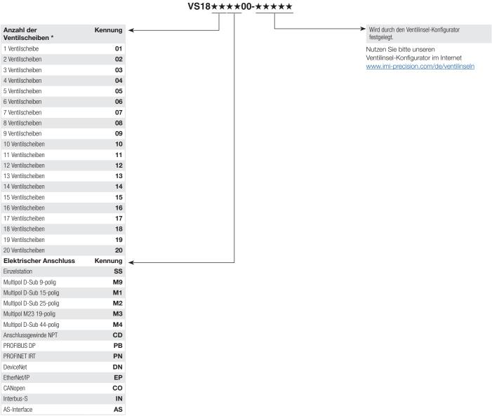
\* Multipol: 2 bis zu 20 Ventilscheiben Feldbus: 2 bis zu 16 Ventilscheiben
