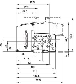
Abmasse für Wandmontage: Die Schlitzlänge beträgt 4,3 mm (max M4 Schrauben) Die Klemmlänge beträgt 35,7mm. Achtung: Verschließen Sie niemals den Anschluss 82/84. da dies zu einer Fehlfunktion des Ventils führen kann.
