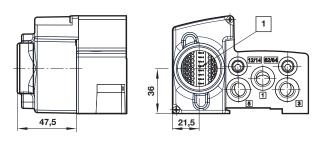
1 Max. Kabelabmessung AWG18
